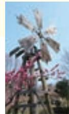
昭和20年代頃まで大阪湾の堺港の浜から高石の浜にかけて畑の灌漑用の風車が700基以上もあり、独特の美しい風景がみられました。現地ではカザグルマと呼ばれ、羽の回転力を上下運動に変えてポンプを動かします。
